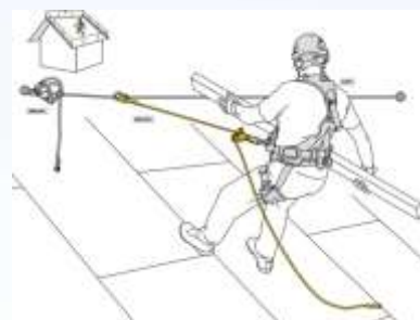
Схема стационарной анкерной линии на двухскатной крыше (1- крыша, 2 – слуховое окно, 3 - лестница, 4 – стационарная анкерная линия)
